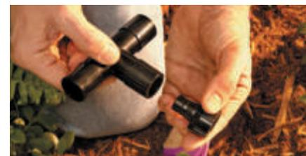
Verwenden Sie ein Easy Fit-T-Stück und einen Adapter mit Innengewinde, um ein PolyFlex-Aufsteiger mit 10-32-Tropfgewinde an den Tropfschlauch anzuschließen.
