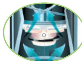
Integriertes Seal-A-Matic Auslaufsperrventil verhindert Pfützenbildung bei tieferliegenden Regnern, ideal für die Verwendung bei unterschiedlichen Geländehöhen
