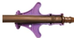
Das Werkzeug hat ebenfalls eine Schräge zur Aufnahme des Tropfrohrs beim Einsetzen eines Anschlussstücks auf der zweiten Seite.
