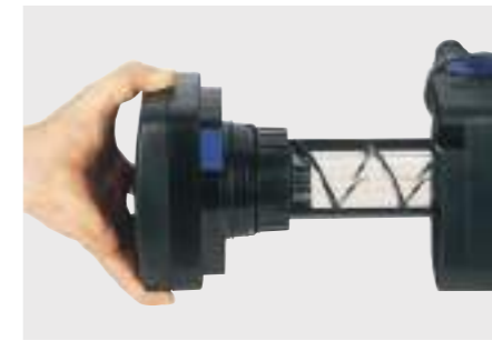
Verschlussmechanik: Schnellverschluss zum leichten Öffnen des Lampengehäuses. Ein Sicherheitsschalter deaktiviert die UVC-Lampe hierbei automatisch zum Schutz vor Augenschädigung.
