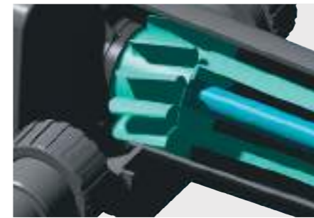
Automatischer Reinigungsrotor: Durch den Wasserstrom wird der Reinigungsrotor kontinuierlich um die Quarzglasröhre herumgeführt und verhindert so Schmutzablagerungen.
