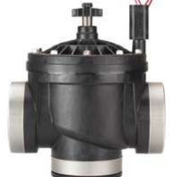
ICV-301 VENTIL Einlassdurchmesser: 3" (80 mm) Höhe: 27 cm Länge: 22 cm Breite: 19 cm
