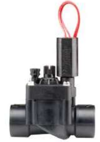
PGV-101-G VENTIL Einlassdurchmesser: 1" (25 mm) Höhe: 13 cm Länge: 11 cm Breite: 6 cm
