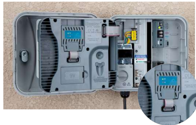
P2C-400-STEUERGERÄT MIT VERBUNDENEM PC-WIFI MODUL
