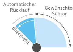
Durch diese patentierte Funktion wird der Regnerkopf unabhängig von der Drehposition auf den ursprünglichen Sektor zurückgesetzt. Der Entkopplungsmechanismus ist vor Beschädigung geschützt und verhindert damit Vandalismus.
