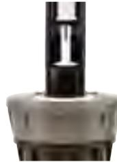
Bei einer fehlenden Düse reduziert die FloGuard Technologie den Wasserdurchfluss im Aufsteiger auf einen 1,6 l/min (3 m hohen) Anzeige-Strahl, um Wasserverschwendung und Erosion zu vermeiden, während eine visuelle Markierung als Reparaturhinweis gesetzt wird.
