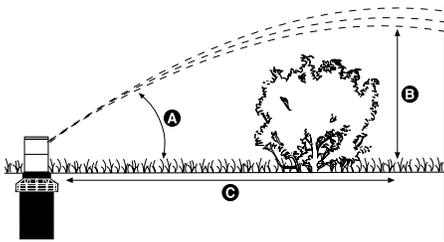
Diese Austrittswinkeldiagramme der Getrieberegnerdüsen sollen bei der Bestimmung helfen, wie nahe ein Regner an einem Objekt wie einem Zaun oder einer Hecke platziert werden kann, ohne das Sprühmuster zu beeinträchtigen. Alle angegebenen Informationen setzen optimale Betriebsdrücke voraus.
