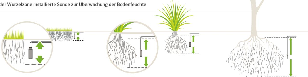
Bei Rasenanwendungen sollte die Sonde ungefähr 15 cm tief in die Wurzelzone platziert werden (an die tatsächlichen Rasenbedingungen anpassen).
