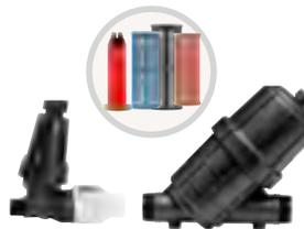
Alle Hunter-Filter verfügen über ein Filtersieb aus Edelstahl und haben einen geringen Druckverlust. 1½" (38 mm) und 2" (50 mm) Filtergehäuse sind mit 80 Mesh (180 Mikrometer), 120 Mesh (125 Mikrometer) und 150 Mesh (100 Mikrometer) und mit Scheibenfilter 120 Mesh (125 Mikrometer) erhältlich.
