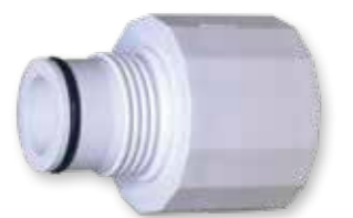
1¼" Innengewinde, ACME x 1" ACME-Adapter, Außengewinde: Ausrüsten vorhandener Rain Bird® Eagle™* 700 1¼" Regner, auf jeden Toro Regner der Serie FLX.
